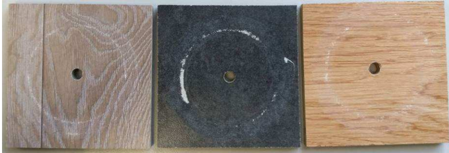
Figura 17. Muestras de laminados sintéticos, L1, L2, L3, una vez alcanzado el punto inicial de desgaste.
