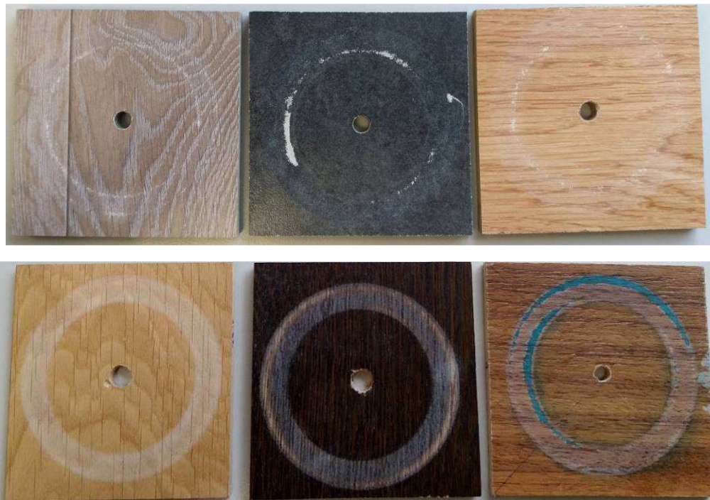
Figura 30. Muestras de madera y laminados, resistencia a la abrasión UNE EN 13329, lija S-42
