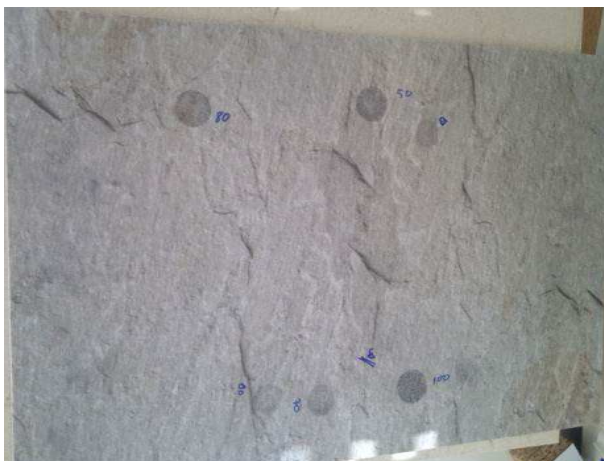
Figura 23. Muestra impresa I1. El problema en esta muestra, no clasificable, es que desde alturas de caída relativamente bajas, aunque no se produce grieta, si que el diámetro de la huella es mayor de 10 mm, valor que establece la norma como límite.
