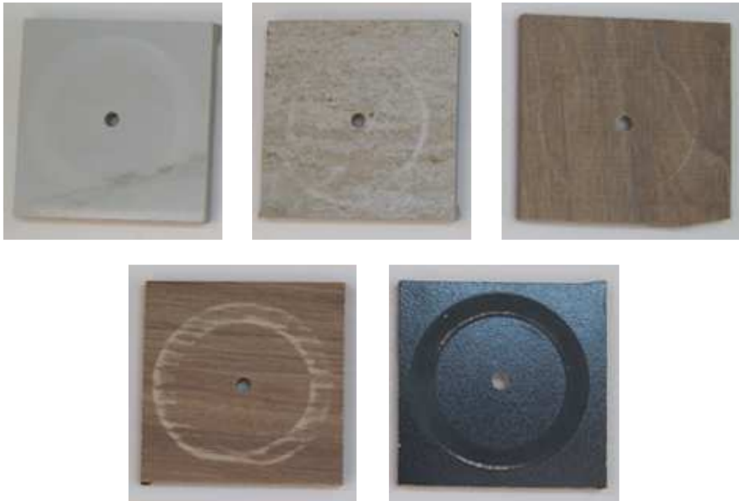
Figura 29. Muestras cerámicas, resistencia a la abrasión UNE EN 13329, lija S-42
