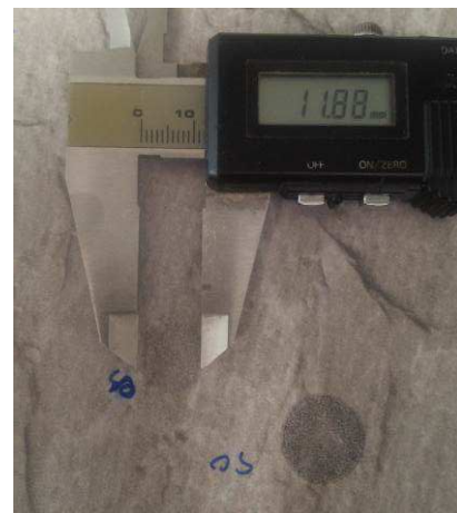
Figura 23. Muestra impresa I1. El problema en esta muestra, no clasificable, es que desde alturas de caída relativamente bajas, aunque no se produce grieta, si que el diámetro de la huella es mayor de 10 mm, valor que establece la norma como límite.
